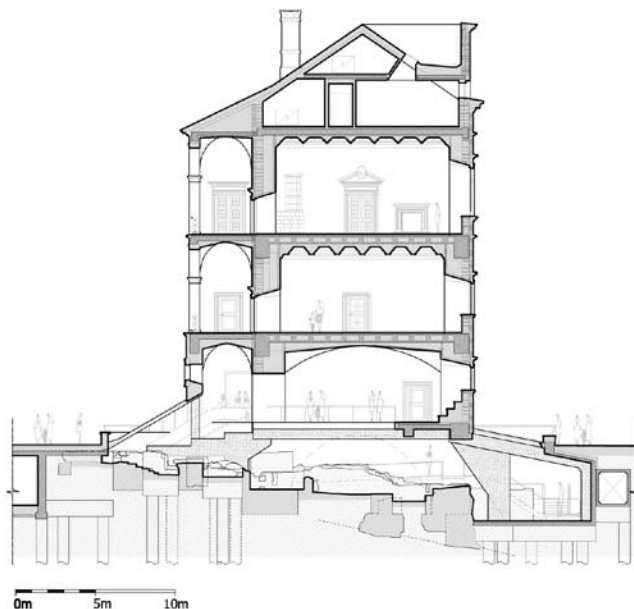
3. Rūmų pietinio korpuso pjūvis; atkūrimo principinis brėžinys. UAB Projektavimo restauravimo institutas
